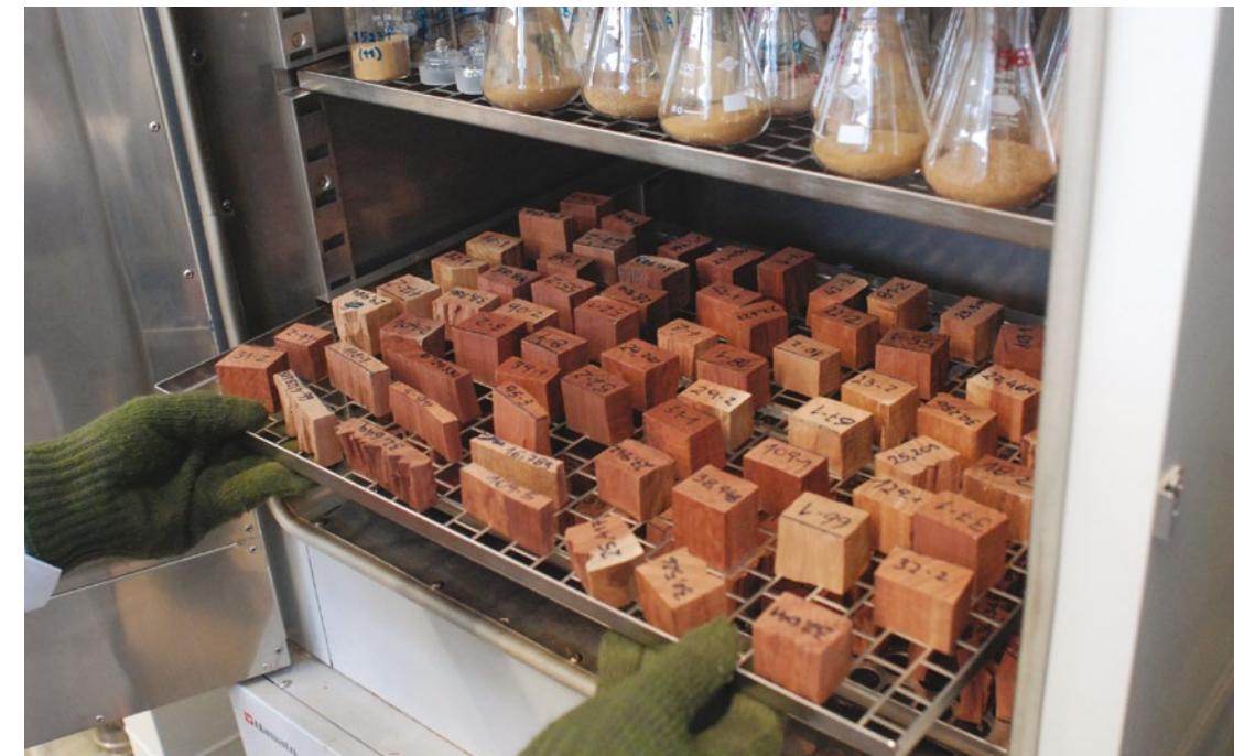
Análisis acreditado de humedad de maderas / Accredited analysis for wood moisture content
