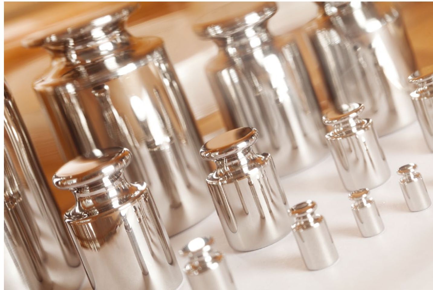
Patrones de masa del Departamento de Metrología Física / Standard weights in the Physical Metrology Department
