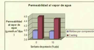
Figura 5. Comparación de la permeabilidad al vapor de agua según método de elaboración y % de conservador. Espesor=0,120 ± 0,010 mm
