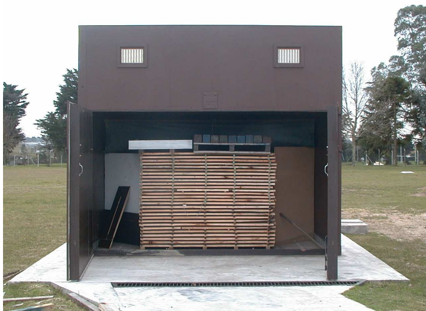
Figura N° 5: Secador solar de LATU con carga de E. grandis .
