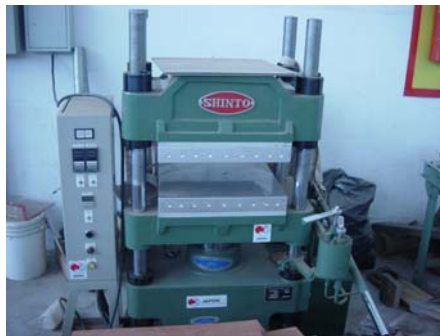
Figura N° 1. Prensa “SHINTO Compression Moulding Machine”
