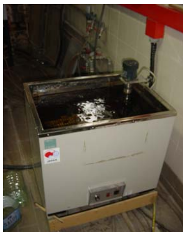
Figura N° 3. Baño termostatzado con control de temperatura.
