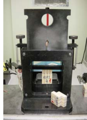
Figura N° 5. Ajuste de probeta
