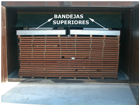
Figura 2.- Estiba con bandejas en la parte superior
