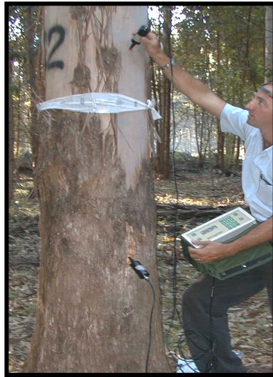
Figuras N° 1 y 2: Evaluación de la calidad de la madera de árboles en pie, equipos Sylvatest y Fakopp
