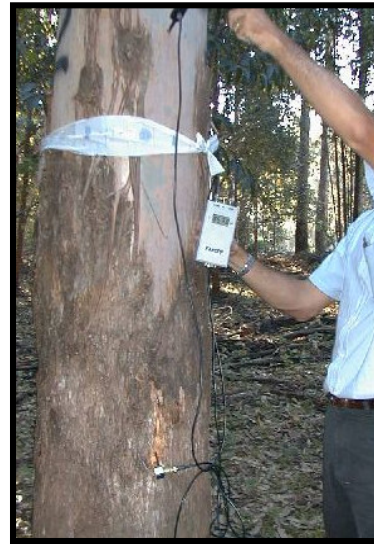
Figuras N° 1 y 2: Evaluación de la calidad de la madera de árboles en pie, equipos Sylvatest y Fakopp
