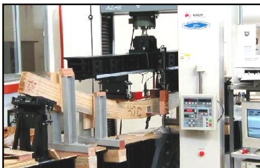
Figura N° 1: Esquema de ensayo de flexión estática 4 puntos en máquina universal.
