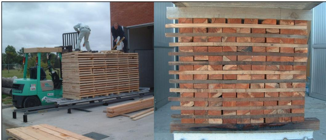
Figura N° 6. Secado de vigas para ensayos mecánicos y fabricación de GLULAM, de *P. taeda* y *E. Grandis*.
