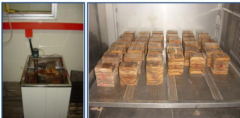
Figura N° 41. Probetas dentro del Baño luego de la Inmersión y las mismas siendo secadas en estufa.
