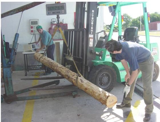
Figura N° 3. Ensayos no destructivos para estimar el MOE en trozas de *P. taeda*, en el monte (FAKOPP) y en el LATU antes del aserrado (FAKOPP, FF ANALYZER).
