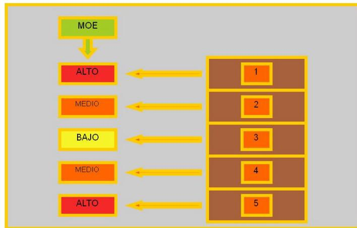
Figura N° 12. Esquema de diseño de la ubicación de las láminas que van a formar la viga según MOE.
