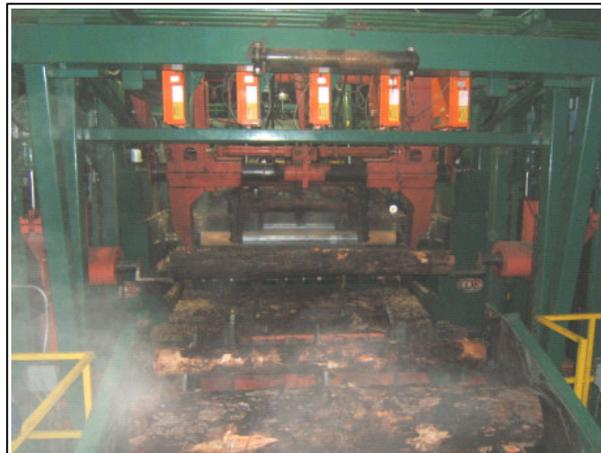
Figura N° 21. Torno automático con troza fijada previo al debobinado.
