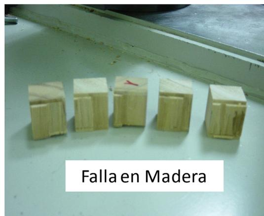
Figura N° 40. Falla en Madera en probetas de Esfuerzo Cortante.
