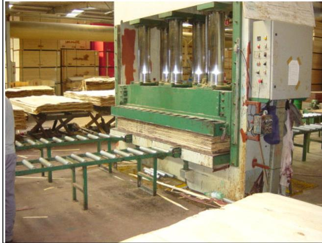
Figura N° 28. Prensa hidráulica para prensado en frío.
