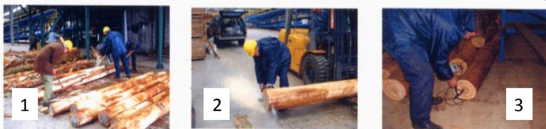
Figura N° 18. Extracción de Rodaja para Densidad y determinación del MOE utilizando el FAKOPP.
