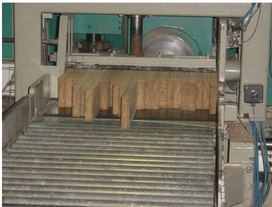
Figura N° 9. Perfiles Finger joint saliendo de la Fresadora.
