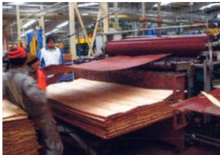
Figura N° 26. Encolado de chapas en Encoladora de rodillos.
