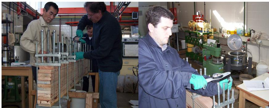
Figura N° 15. Prensado de Vigas laminadas en LATU.
