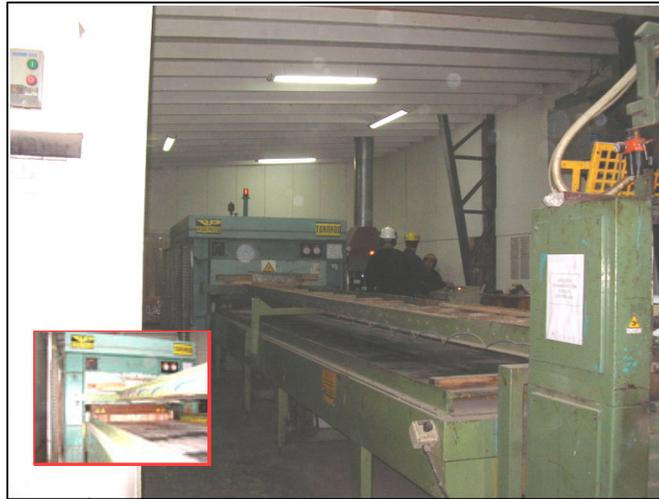
Figura N° 14. Prensa Hidráulica de alta frecuencia.
