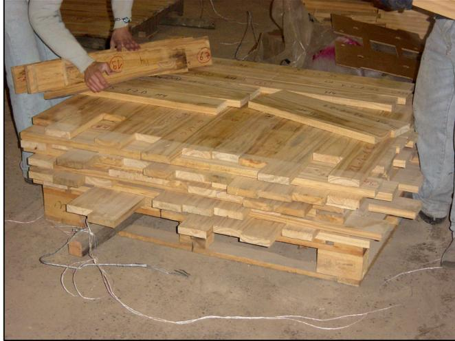
Figura N° 8. Piezas para elaboración de Vigas Laminadas.
