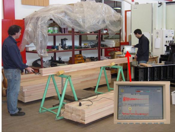
Figura N° 34. Viga laminada siendo evaluada a través del FFT ANALYZER.
