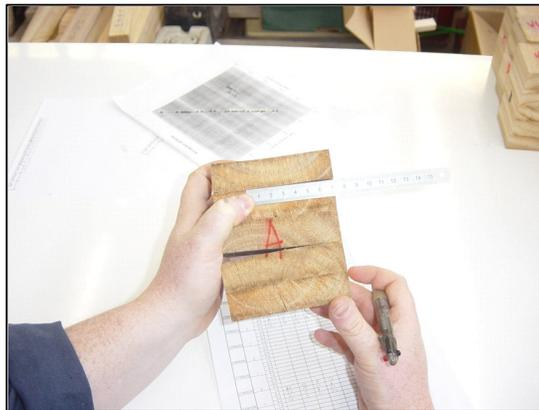
Figura N° 42. Determinación del % de Delaminación.
