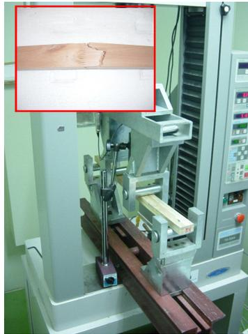
Figura N° 43. Probeta de Finger Joint sometida al ensayo de Flexión estática.
