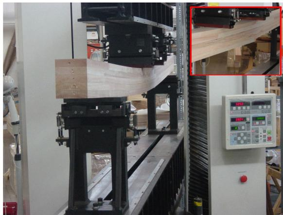
Figura N° 36. Viga laminada siendo ensayada en Máquina Universal.
