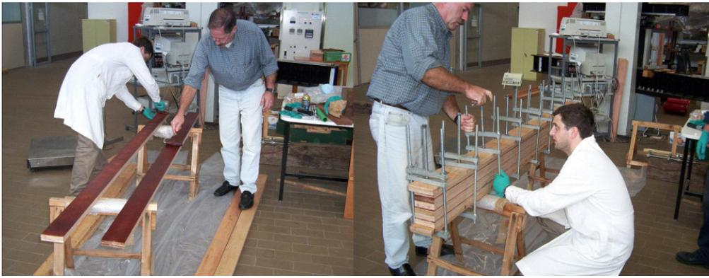
Figura N° 32. Elaboración de Vigas LVL, encolado y prensado.
