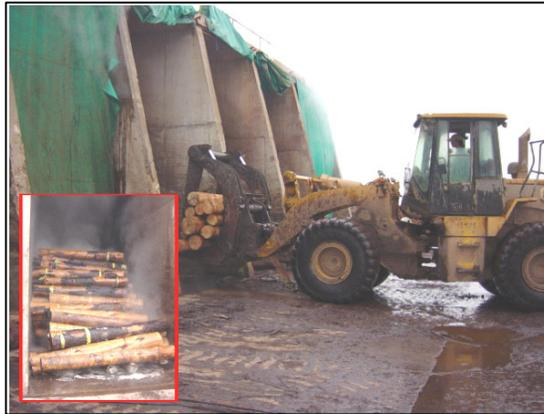
Figura N° 19. Cámaras de Vaporizado.
