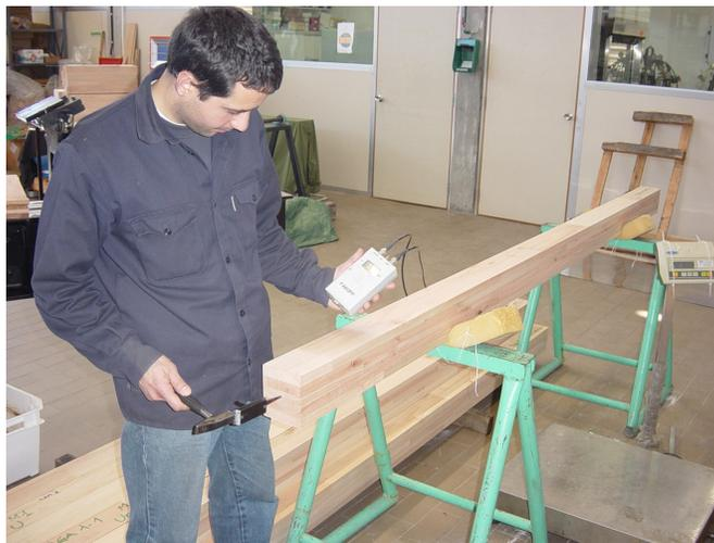
Figura N° 35. Viga laminada siendo evaluada a través del FAKOPP.
