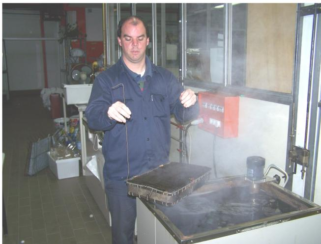
Figura N° 30. Extracción de Probetas del baño termostatzado.
