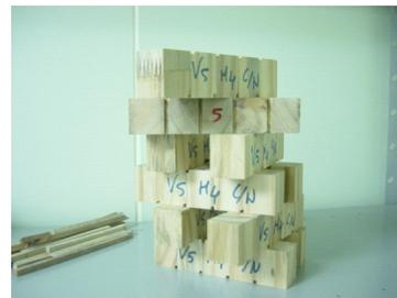
Figura N° 38. Esquema y foto de probetas de Esfuerzo cortante en la línea de encolado.
