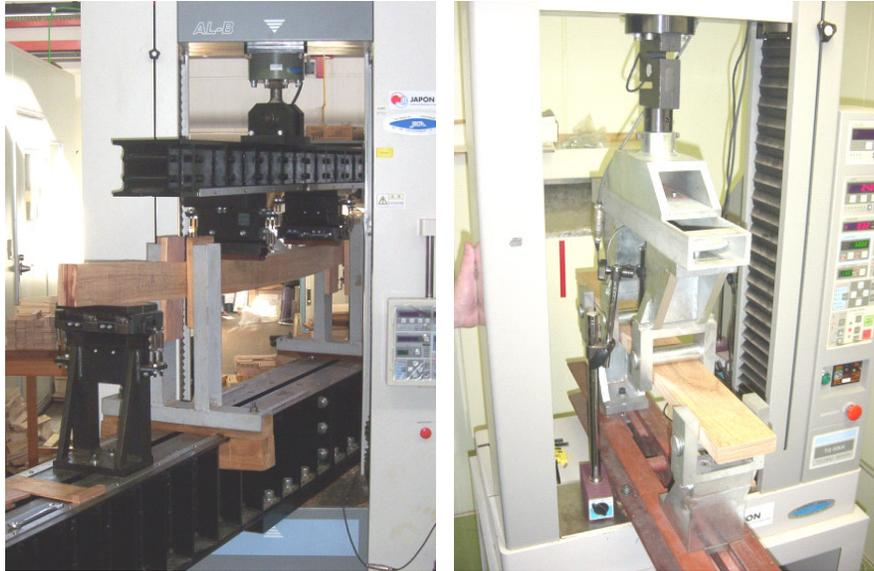
Figura N° 33. Ensayo de Flexión estática en vigas y pequeñas probetas LVL.
