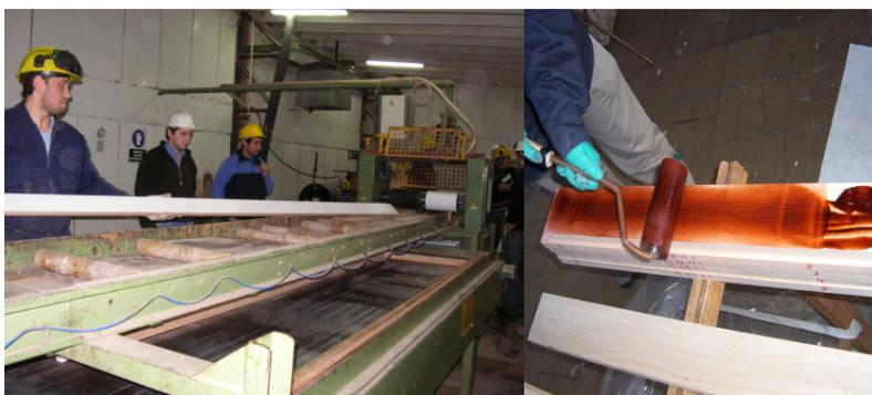
Figura N° 13. Encolado de láminas utilizando encoladora mecánica y utilizando rodillo manual.
