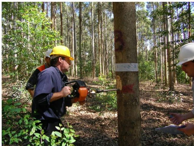
Figura N° 2. Ensayo no destructivo para estimar la densidad aparente en árboles, *E. grandis* en pie, extracción de tarugo 12 mm de diámetro con extractor a nafta.
