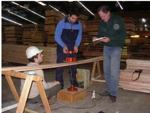
Figura N° 11. Flexión estática por pesas en láminas finger joint.
