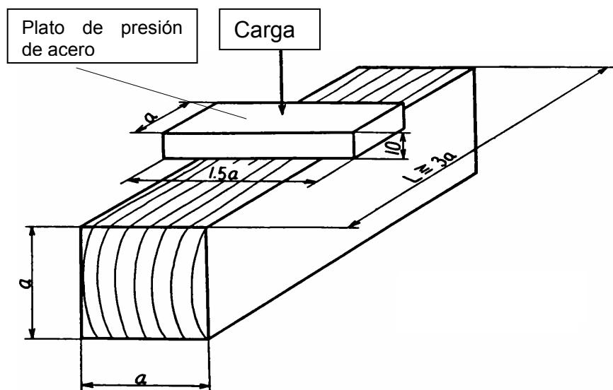
Al igual que en compresión perpendicular, en este ensayo se presenta una tabla resumida de los resultados obtenidos. El resultado de resistencia máxima se calcula con la carga para un 5% de deformación en el espesor de la probeta
