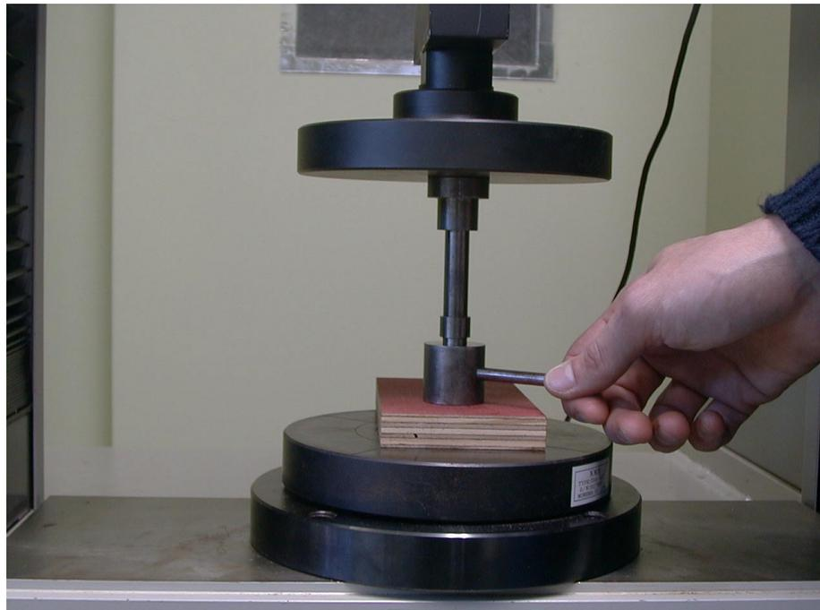
Figura 9 : Accesorio para el ensayo de dureza Janka.
