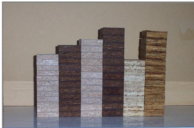
Figura 6: Disposición de probetas para su colocación en baño termostatzado; probetas de **PB** y **OSB** de 12 y 15 mm de espesor ensayadas y sin ensayar.
