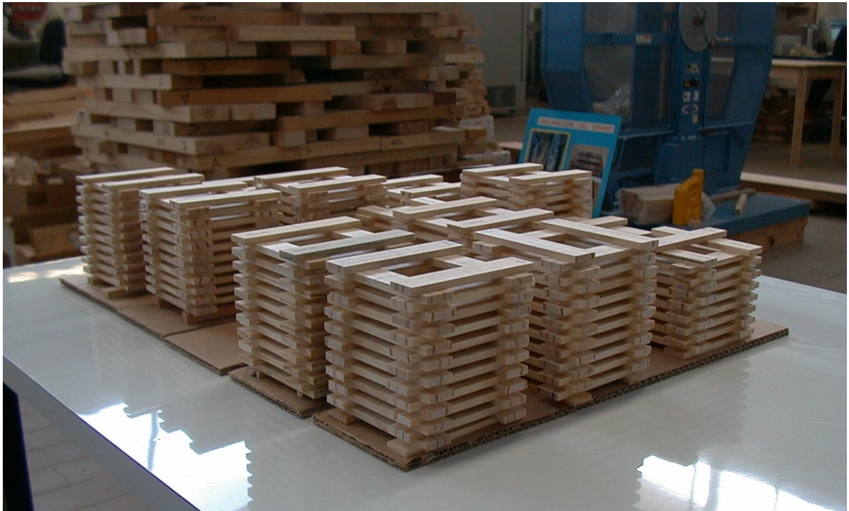
Figura 7: Disposición de tablillas de Pinus elliottii y taeda para acondicionar
