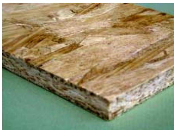
Tableros de Virutas Orientadas (OSB) de 12 mm de espesor
