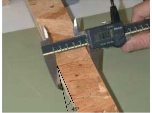
Fig. 9: Determinación del ancho de probetas.
