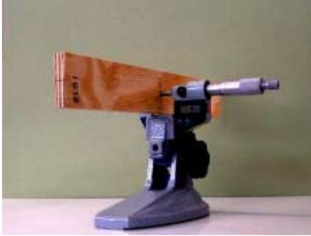
Fig. 8: Determinación del espesor de probetas.
