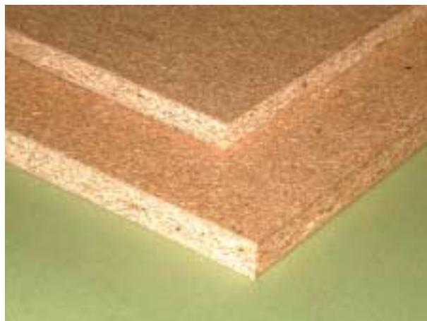
Tableros de Partículas (PB) de 12 y 15 mm de espesor.
