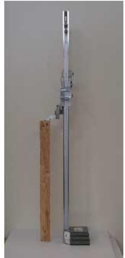
Fig. 10: Determinación del largo de probetas
