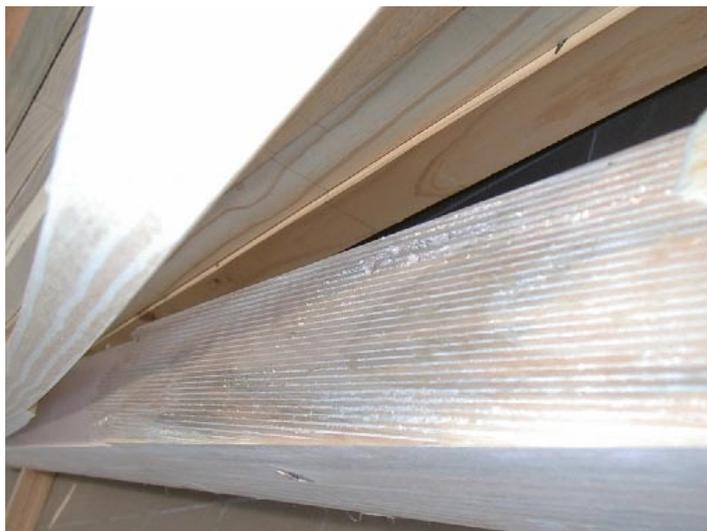
**Figura N°15: Falla por delaminación en *Pinus taeda* provocada durante el ensayo de flexión estática.**
