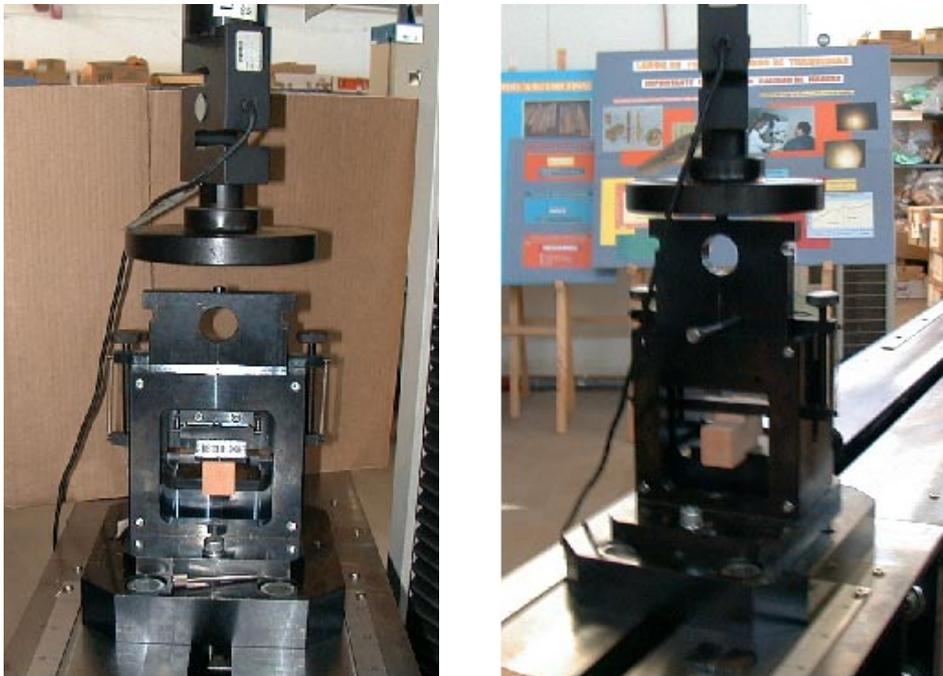
**Figura N°12: Accesorio para ensayo de esfuerzo cortante.**
