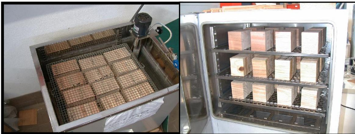
**Figura N°13: Ensayo de delaminación. Baño en agua caliente y estufa**
