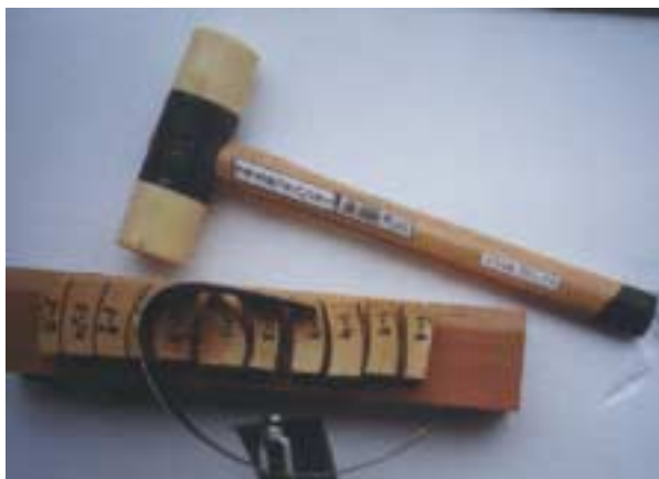
Figura N°5: Fotografía de cuchilla formadora de probetas radiales.
