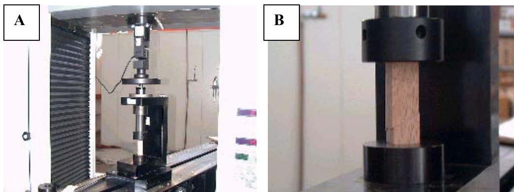
Foto N° 4: A → Ensayo de compresión paralela a las fibras. B → Detalle de rotura de la probeta
