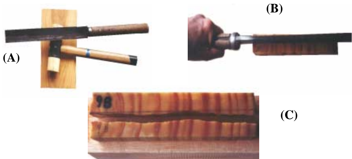
FIGURA N°3: Implementos de corte: (A) Martillo y cuchilla; (B) Corte; (C) Probeta cortada.
