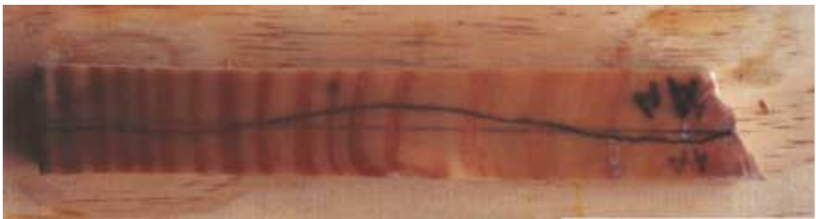
FIGURA N°5: Probeta de árbol N°4 , desvío pronunciado.
