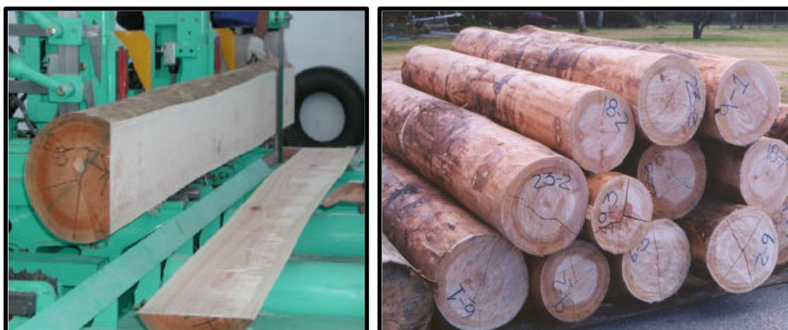
Figura N° 9 : Aserrado de las trozas para obtención de tablas (2"x 6")
