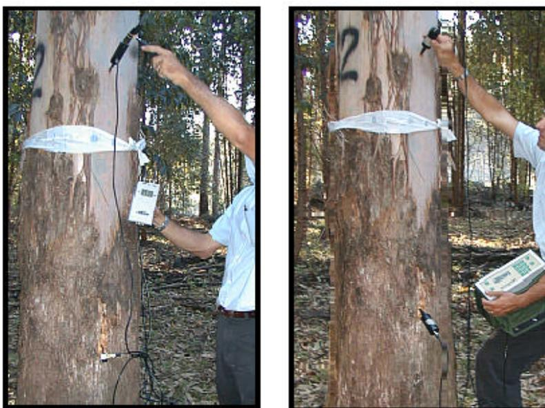
Figuras N° 2 y 3: Estimación del Módulo de Elasticidad en árboles en pie, equipos Fakopp y Sylvatest
