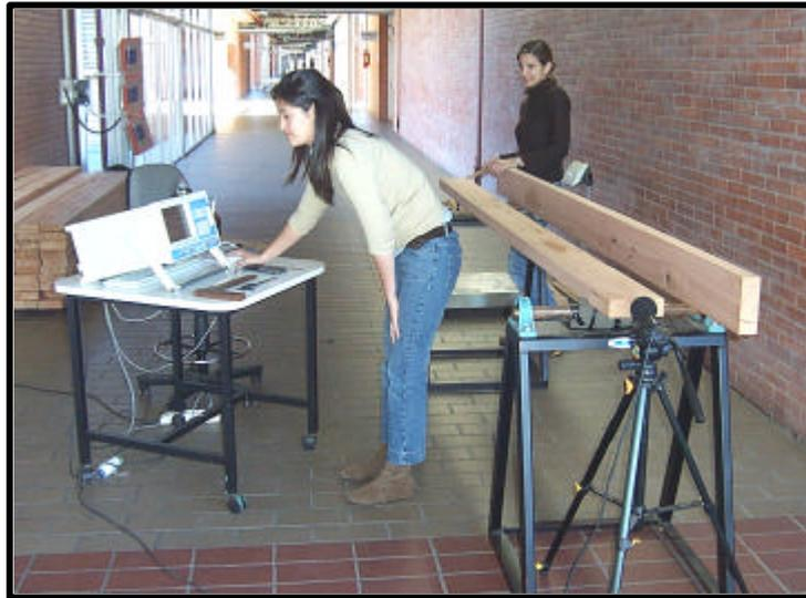
Figura N° 10: Estimación del MOE en tablas mediante el FFT Analyzer.
