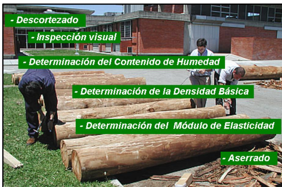
Figura N° 4: Orden en la realización de los trabajos en las trozas.
