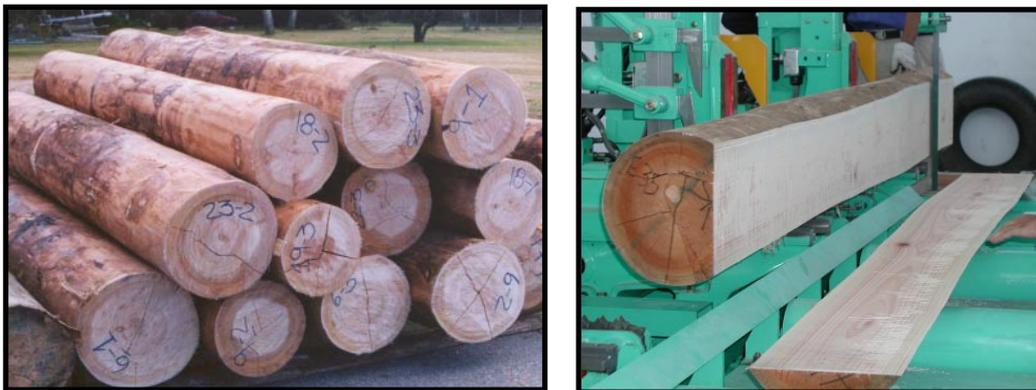
**Figura N° 7 : Aserrado de las trozas para obtención de tablas (2"x 6")**
