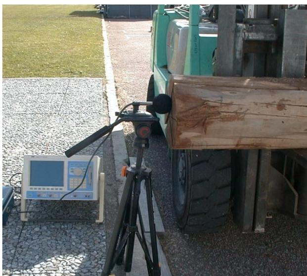
**Figura N° 5: Determinación Módulo de Elasticidad en trozas mediante FFT Analyzer**
