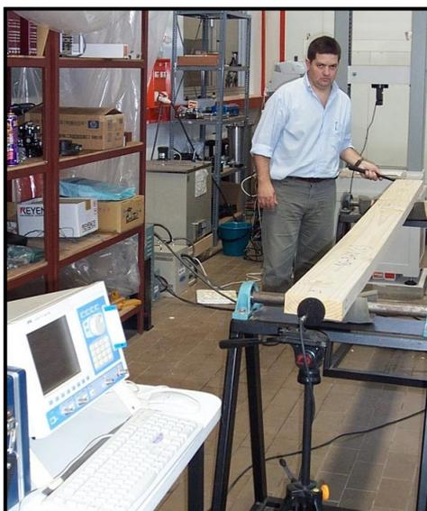
**Figura N° 8: Determinación del MOE en tablas mediante el FFT Analyzer.**
