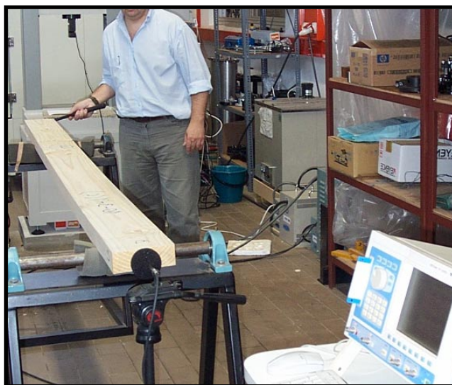
Figura N° 8: Determinación del MOE en tablas mediante el FFT Analyzer.
