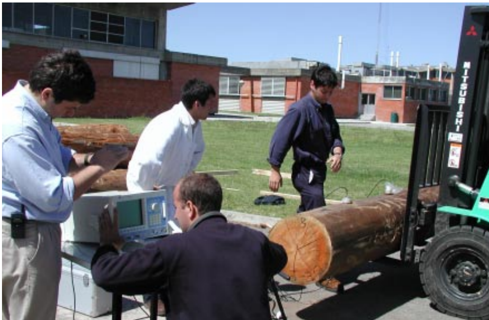
Figura N° 5: Determinación Módulo de Elasticidad en trozas mediante FFT Analyzer
