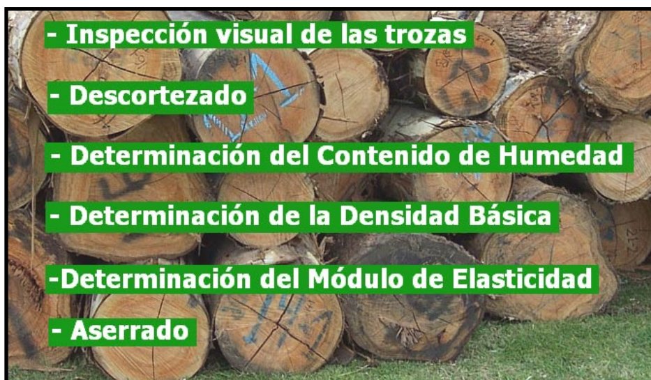
Figura N° 2: Orden en la realización de los trabajos.
