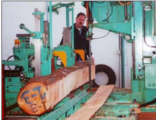
Figuras N° 7 y 8: Aserrado de las trozas para obtención de tablas (2"x 6")
