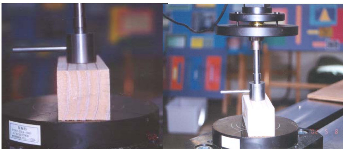
Figura N° 13: Ensayo de dureza Janka, probeta de ensayo y accesorio.
