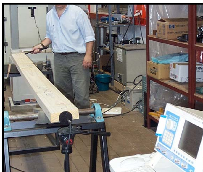
Figura N° 9: Determinación del MOE en tablas mediante el FFT Analyzer.
