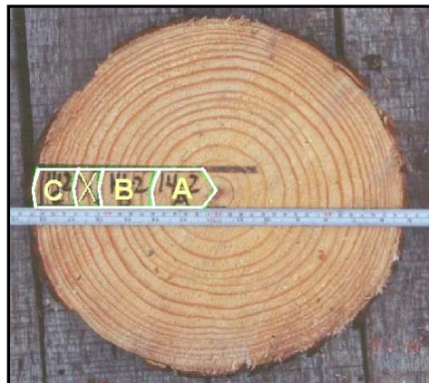
Figura N° 2: Esquema de preparación e identificación de las probetas.
