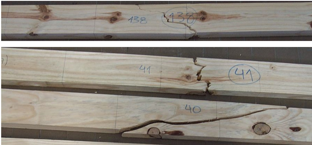
Figura N° 16: Tipo de la rotura por tensión y por corte en área nudosa
