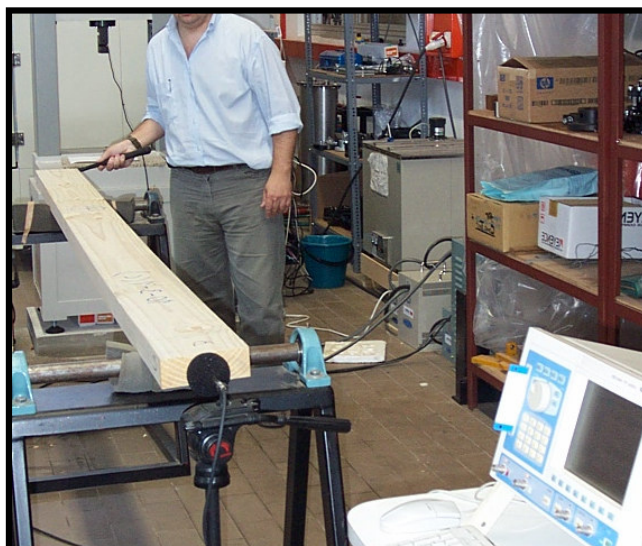
Figura N° 11: Determinación del MOE en tablas mediante el FFT Analyzer.
