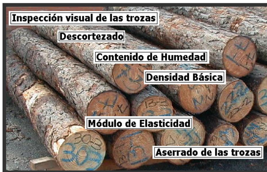
Figura N° 2: Orden en la realización de los trabajos.
