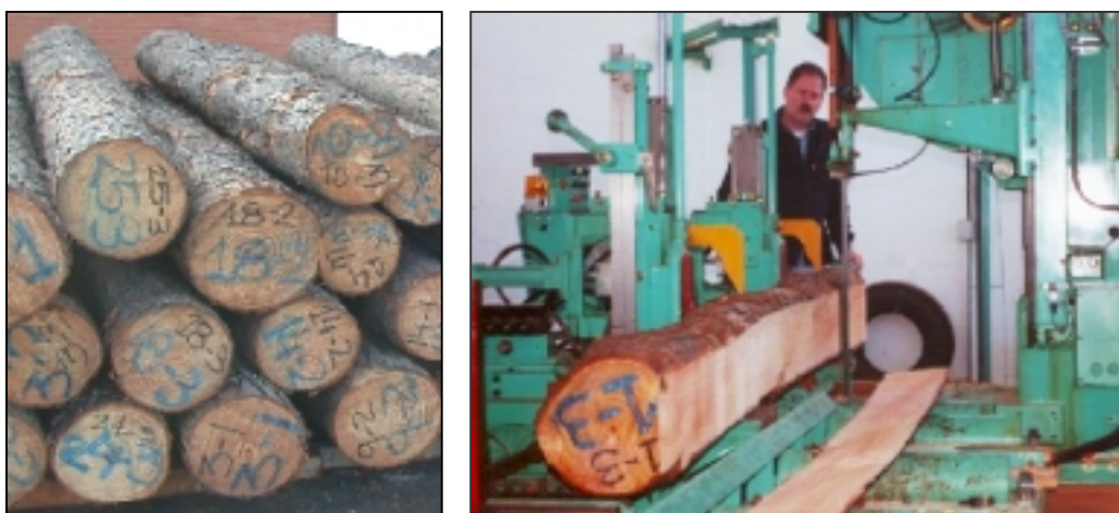
Figuras N° 8 y 9: Aserrado de las trozas para obtención de tablas (2"x 6")
