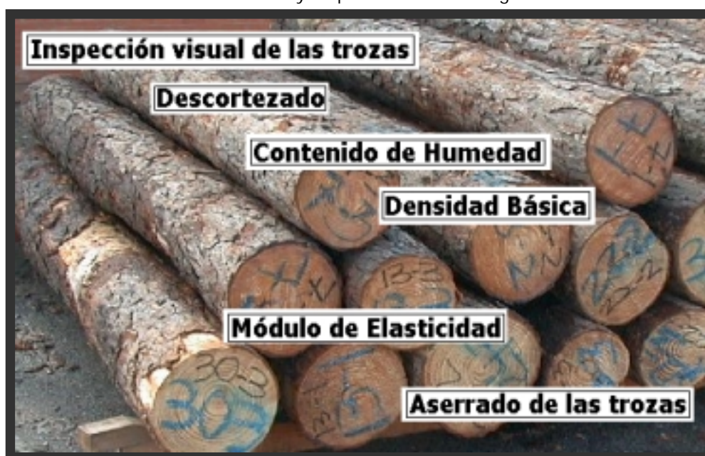
Figura N° 2: Orden en la realización de los trabajos.
