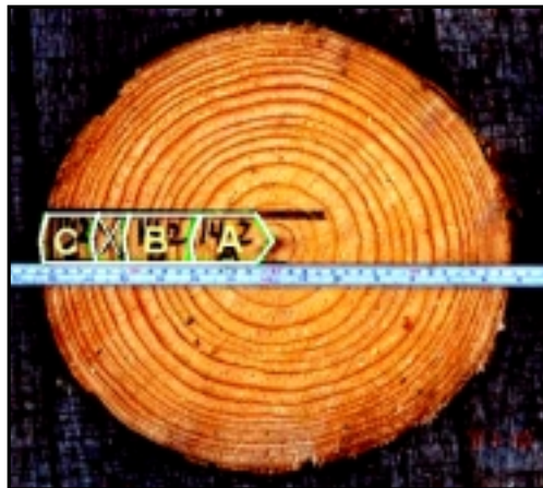
Figura N° 3: Esquema de preparación e identificación de las probetas.
