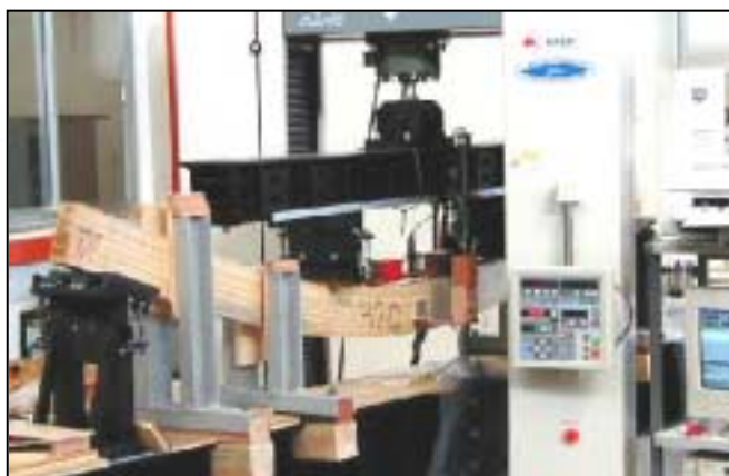
Figura N° 10. Esquema de ensayo de flexión estática 4 puntos en máquina universal.
