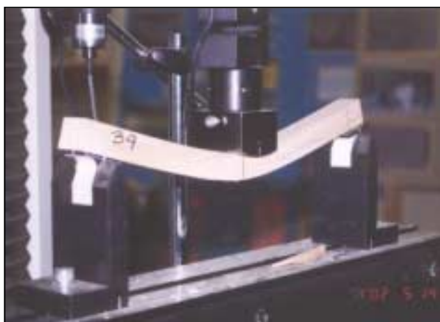
Figura N° 12: Esquema y ensayo de flexión estática en 3 puntos en máquina universal
