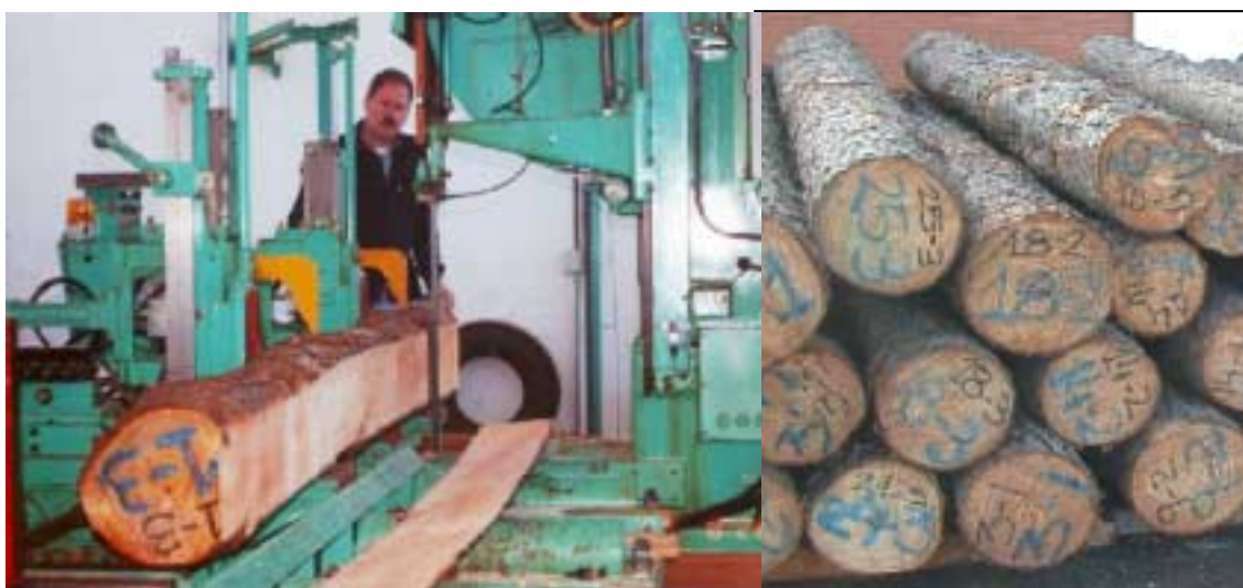
Figuras N° 7 y 8: Aserrado de las trozas para obtención de tablas (2"x 6")
