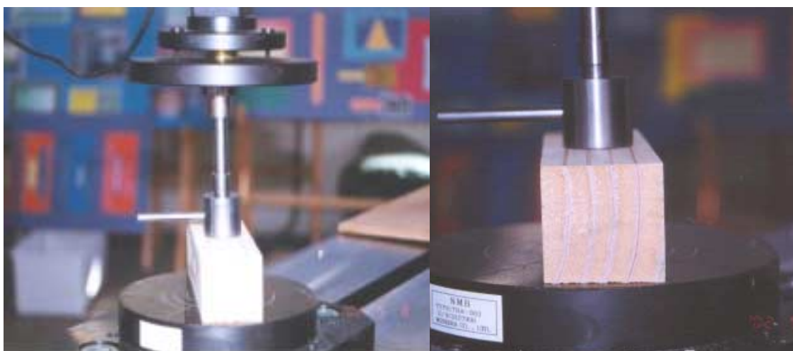
Figura N° 14: Ensayo de dureza Janka, probeta de ensayo y accesorio.
