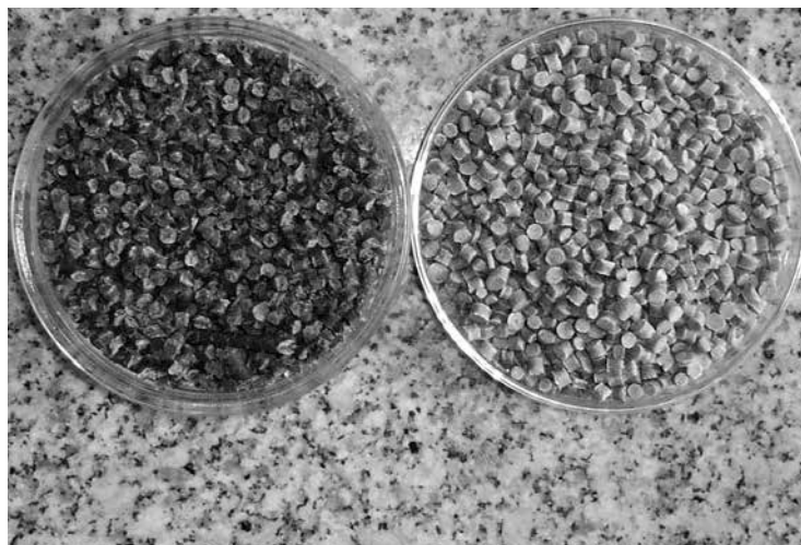
FIGURA 2. FOTO DEL WPC OBTENIDO EN EL LABORATORIO DE POLÍMEROS. A LA IZQUIERDA, EUCALIPTO, Y A LA DERECHA, PINO. FUENTE: FOTOGRAFÍA DE CLAUDIA BORDÓN
