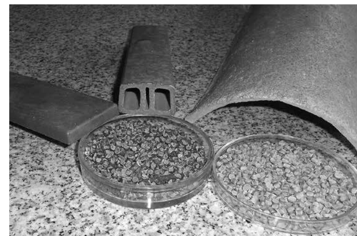
FIGURA 1. WPC FABRICADO EN URUGUAY. FUENTE: FOTOGRAFÍA DE CLAUDIA BORDÓN
