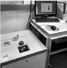
FIGURA 4 Y 5. ENSAYO DE DIÁMETRO MEDIO DE FIBRA. FUENTE: FOTOGRAFÍAS DEL EQUIPO DE AUTORES
