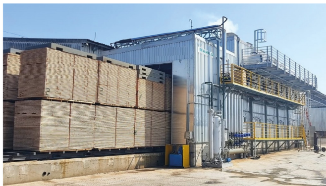
FIGURA 23. Horno de secado de vagonetas
