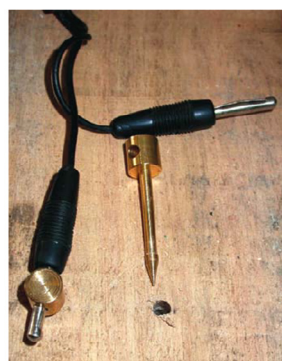
FIGURA 25. Medidores de humedad y esquema mostrando colocación
