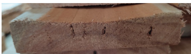
FIGURA 11. Grietas internas por secado severo en tablas de 1" de E. grandis
