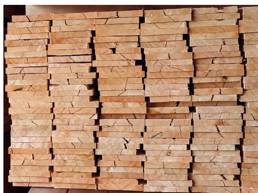
FIGURA 12. Grietas y rajaduras en los extremos de tablas de E. grandis
