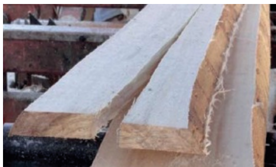
FIGURA 13. Rajado de la tabla durante el aserrado desde la cabeza
