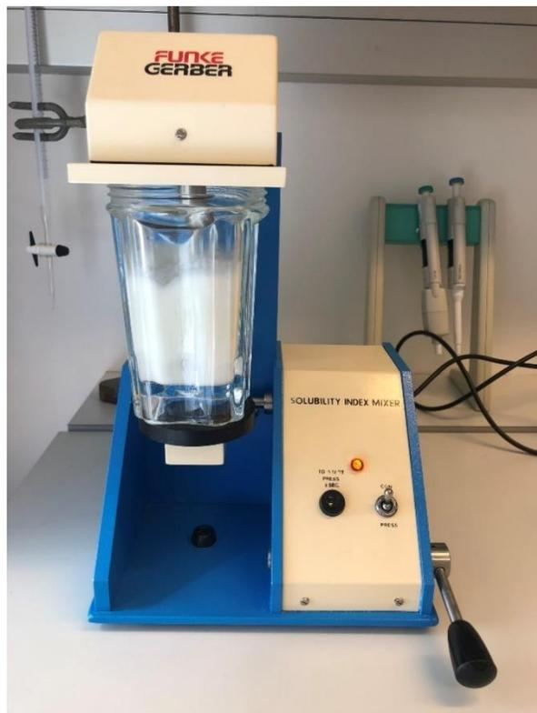
Figura 4.5. Mezcladora Funke Gerber para ensayo de índice de solubilidad.
