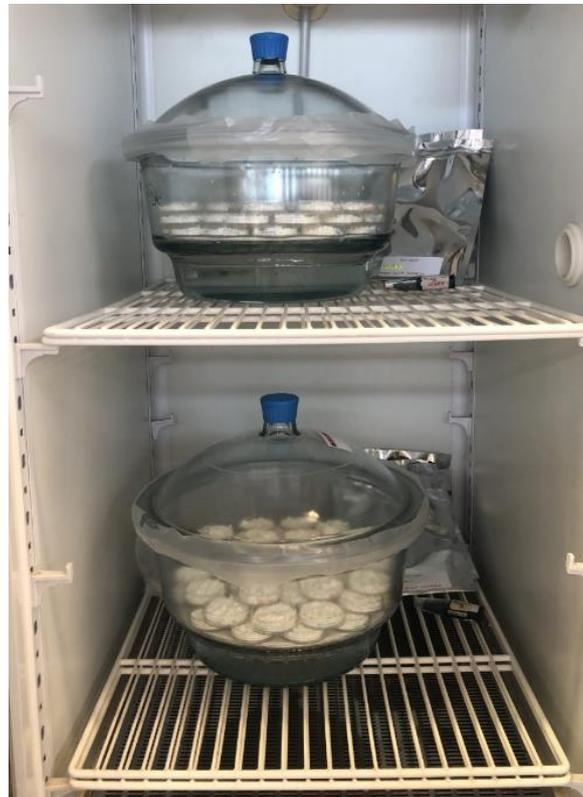
**Figura 5.2.** Cámara de almacenamiento a 25 °C, conteniendo las bolsas con muestra para almacenamiento en condiciones herméticas y los desecadores para almacenamiento a 58 % HR.
