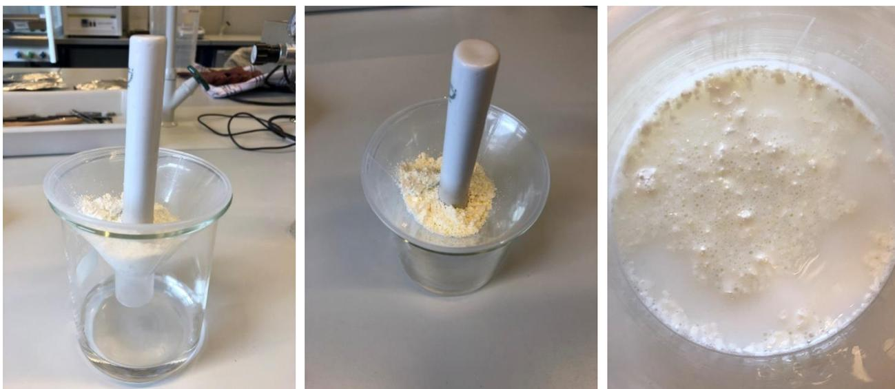
Figura 4.4. Imágenes de la determinación de humectabilidad.
