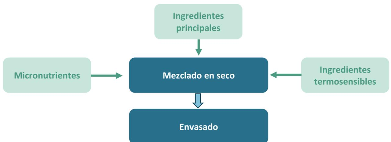
**Figura 1.3.** Esquema del proceso de producción de fórmulas infantiles en polvo por el método de mezcla en seco (adaptada de: Masum et al. (2020c)).
