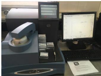
Fig 2. Calorímetro Diferencial de Barrido. DSC Q2000, TA Instruments
