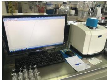
Fig 3. Medidor Rápido de Viscosidad. RVA4500, Perten Instruments.
