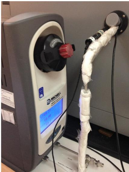
**Fig. 2.** Patrón de medición de punto de rocío y conexiones aisladas.
