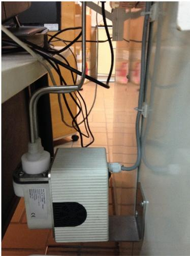
**Fig. 1.** Bomba que alimenta al patrón de medición punto de rocío.
