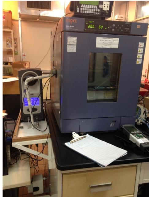
**Fig. 3.** Sistema de medición de higrómetros, patrón de medición de punto de rocío y cámara ambiental.
