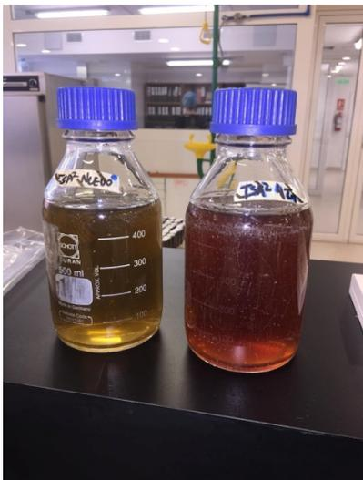
**Figura N°16:** Medios de cultivos marca ISA Liofilchem y Oxoid recién salido del autoclave.
