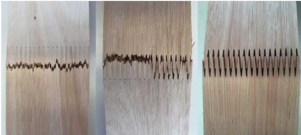
Figura 5: Modos de fallo: a) madera, b) mixto, c) adhesivo.
