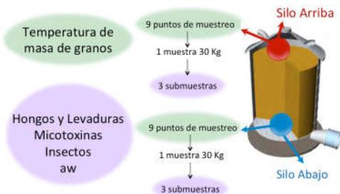
Figura 1- Esquema de extracción de muestras y determinaciones realizadas. Esquema del silo de Abadía y Bartosik, 2013.
