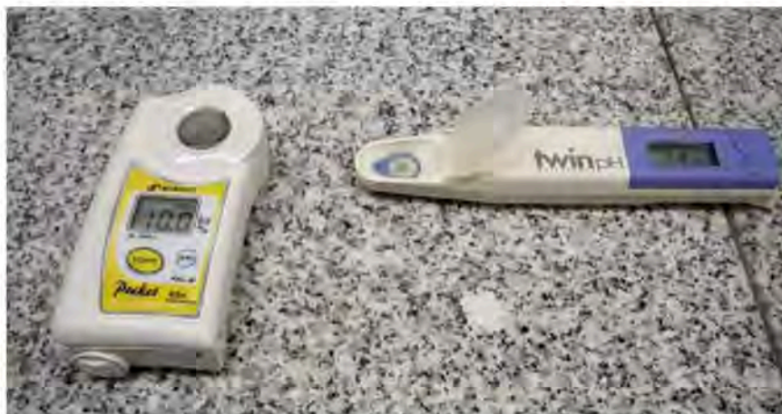
Figura 2.8. pHmetro y refractómetro utilizados para la determinación del pH y los sólidos solubles, respectivamente.
