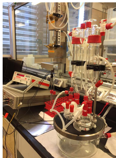
Figura 6. Sistema de medición de pH.
