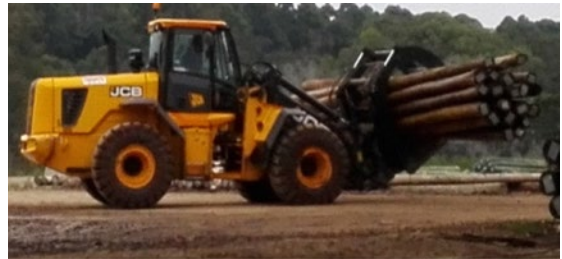
Figura 14. Cargador frontal transportando postes.
