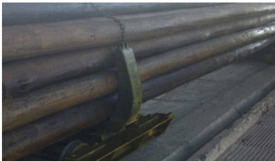
Figura 13. Salida de postes impregnados de autoclave.
