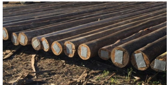
Figura 10. Camas para control e identificación de postes previo a la impregnación.
