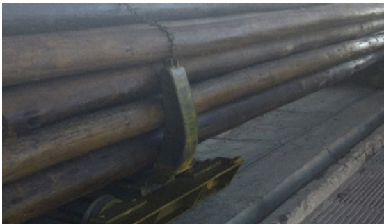
Figura 13. Salida de postes impregnados de autoclave.
