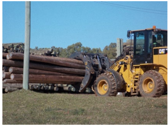
Figura 15. Cargador frontal en trabajo de movimiento de postes.
