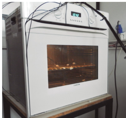
Figura 1. Horno eléctrico utilizado en las determinaciones experimentales, con las termocuplas colocadas.
