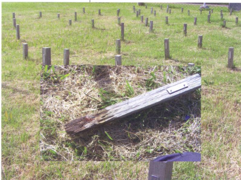
Ensayo de campo de estacas de madera de *Pinus sp.* tratada con CCA-C. Detalle de estaca deteriorada por exposición de hongos de pudrición y a la intemperie. Norma EN 252.
