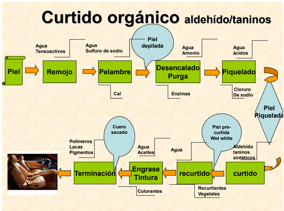
Figura 1: Diagrama de flujo de la producción de cuero libre de cromo para tapicería automotriz.
