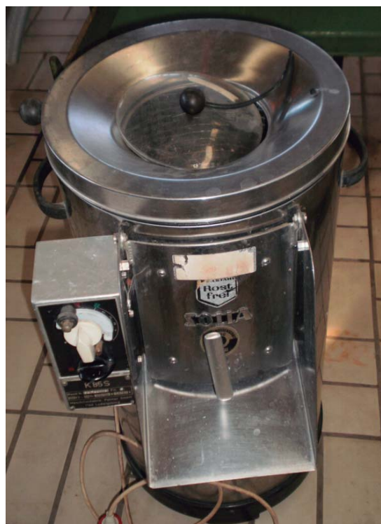
Figura 16. Separador de fibra centrífugo discontinuo diseñado por el técnico Diego Gioscia. Fuente: LATU, Proyectos Agroalimentarios, 2009.
