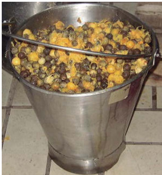
Figura 15. Fibra y cocos a la salida de la tamizadora. Fuente: LATU, Proyectos Agroalimentarios, 2009.
