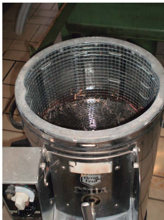
Figura 16. Separador de fibra centrífugo discontinuo diseñado por el técnico Diego Gioscia. Fuente: LATU, Proyectos Agroalimentarios, 2009.
