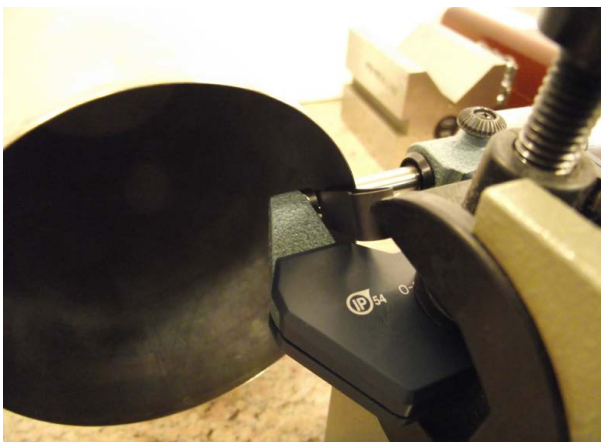
Figura 5. Medición del espesor de chapa.
