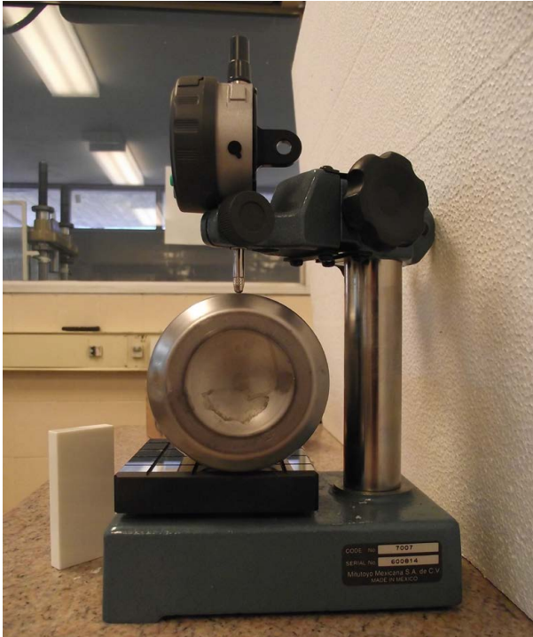
Figura 4. Medición del diámetro exterior de la campana.
