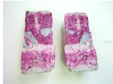
Fig. 10 Testigo carbonatado atomizado con fenolftaleína. Vista interior.
