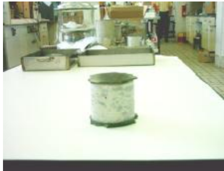
Fig. 11 Testigo encabezado con mortero de azufre, para ensayar Resistencia a la Compresión.
