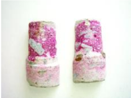
Fig. 9 Testigo carbonatado atomizado con fenolftaleína. Vista exterior.
